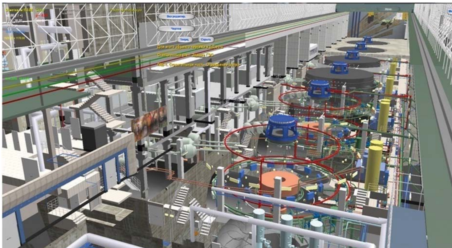
Визуализация внутренних помещений и сетей ГЭС в интерактивной модели на основе визуализации модели в 3ds Max
